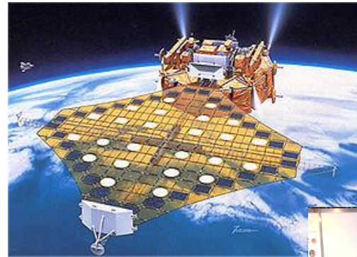
人工衛星のパネル (ミウラ折り)
